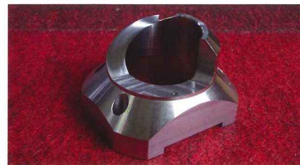
▲MX-520で5軸加工したサンプル
